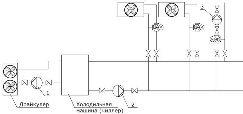
Рис. 16 Схема системы охлаждения и кондиционирования воздуха
