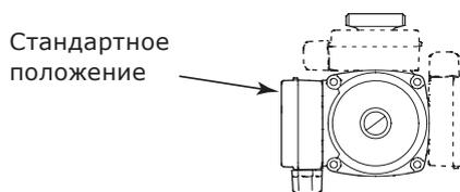
Рис. 9 Возможное положение блока управления для системы отопления
