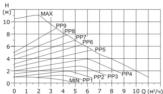
Рис. 42 Кривые режима управления пропорционального изменения давления
