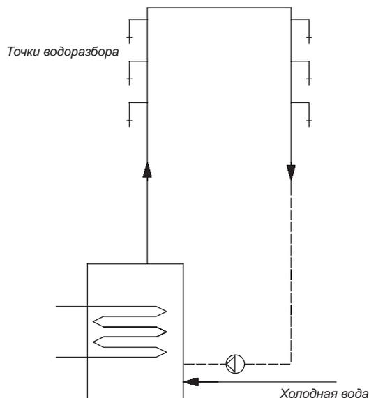
Рис. 12 Одноконтурная схема контура рециркуляции горячей воды
