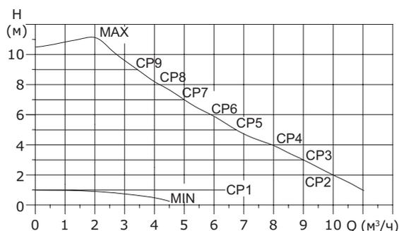
Рис. 43 Кривые режима управления с постоянным значением давления.
