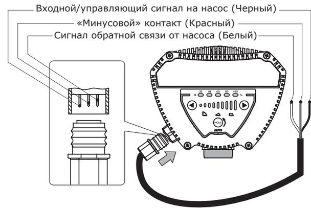
**Рис. 46** Схема подключения ШИМ-сигнала
