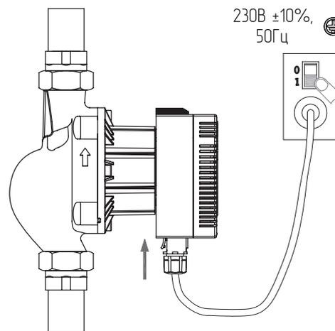
Рис. 40 Электроподключение насоса
