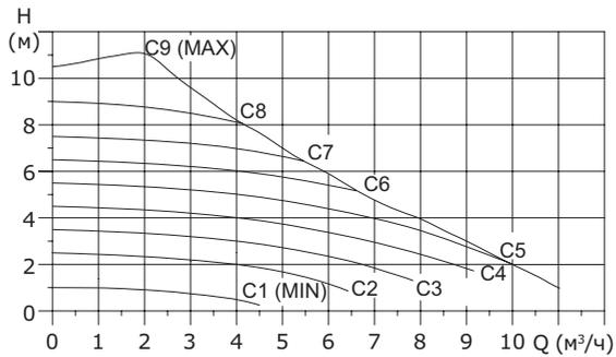
**Рис. 44** Кривые режима управления при фиксированной частоте вращения
