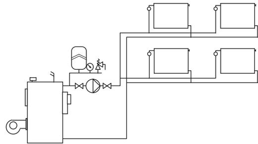
Рис. 5 Двухтрубная система отопления
