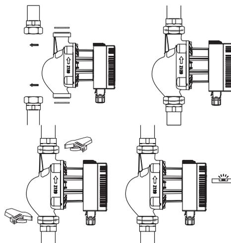
Рис. 39 Монтаж насоса
