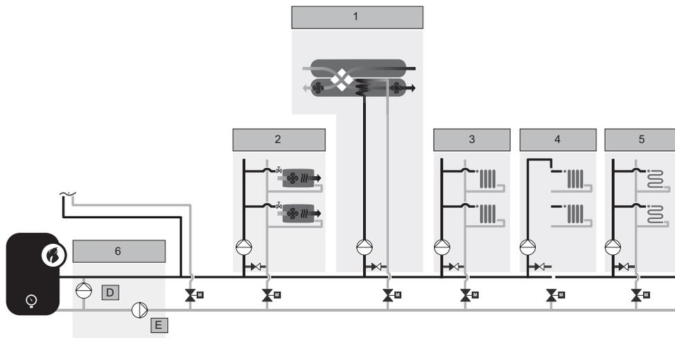
Рис. 51 Функциональная схема системы отопления в коммерческом здании
