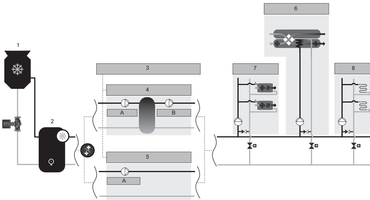
Рис. 52 Функциональная схема системы охлаждения в коммерческом здании
