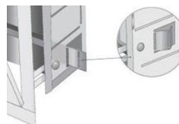
3.6. Откидная дверца шкафа имеет завёртку, удерживающую дверцу в закрытом положении. Управление завёрткой может осуществляться отвёрткой с плоским шлицом.
